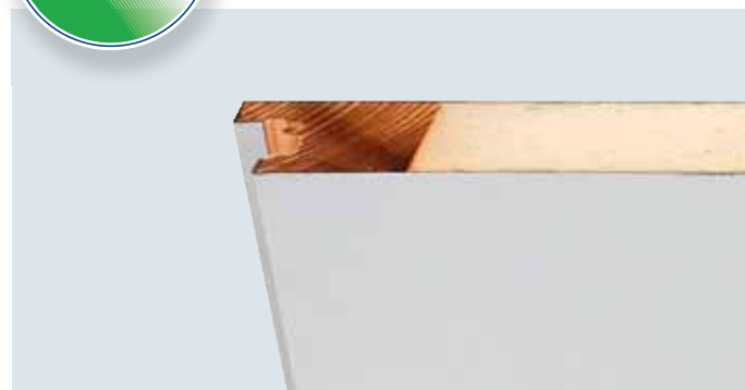
Vysoká tepelná izolácia vytvorená termicky oddeleným krídlom dverí, ktoré je vyplnené tvrdnou PU penou bez freónov.
